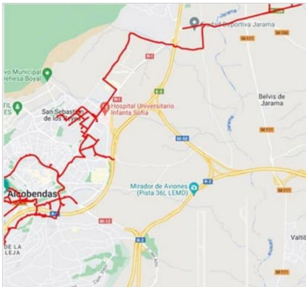
Ilustración 23. Fibra óptica Colt
